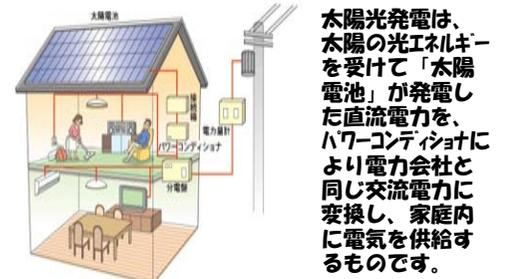
一般の系統連系方式の太陽光発電システムでは電力会社の配電線とつながっているので、発電電力が消費電力を上回った場合は、電力会社へ逆に送電して電気を買い取ってもらうことができます。
